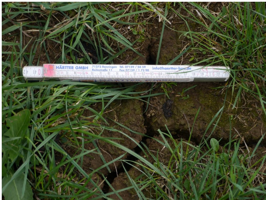
Bild 8: Schrumpfrisse bei Bohrung BK 4.
